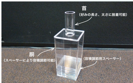
【図6】アクリルの特製「自在音圧吸収型吸音ビン」
