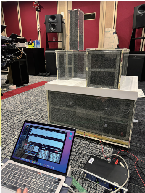
【図 9】完成！そして測定（ニードルパンチカーペットで吸音した様子）
